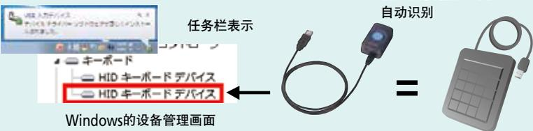
通过连接USB Input Tool，可自动识别HID键盘设备(Windows标准的驱动程序)。
