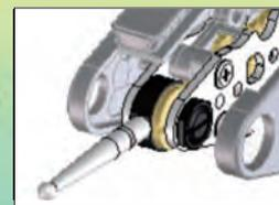
将测头固定在运行机构上
