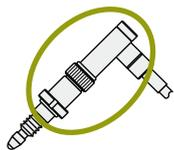
在安装孔 (建议尺寸 :  $\varnothing 9.5_{H6}$ ) 中插入测微计并使用提供的锁紧螺母进行固定, 确保滚花部分在测微计主体的中间并使用专用扳手将锁紧螺母拧紧。请确保操作期间无外力和扭矩施加在电缆上, 否则可能造成损害。可使用可选安装支架。此外, 当装配安装支架时, 建议尺寸 B 为 11.5mm。(参见 32 页)
